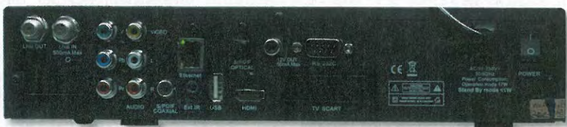
Mithilfe des Netzwerkanschlusses am Heck des HDTV-Receiver sind derzeit noch keine multimedialen Zusatzanwendungen nutzbar, einzig für Verteilprotokolle wird die Schnittstelle momentan genutzt
