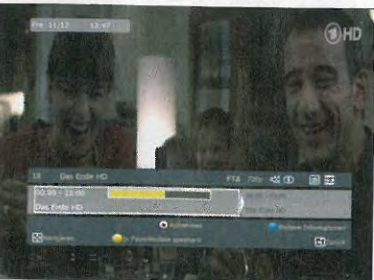
Im Infobalken, der beim Kanalwechsel sichtbar wird, werden EPG-Daten zur aktuellen Sendung gezeigt
